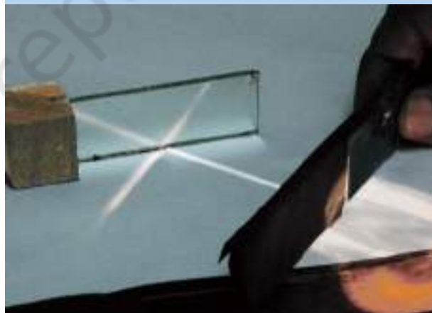
चित्र 13.1 : परावर्तन दर्शाने की व्यवस्था
